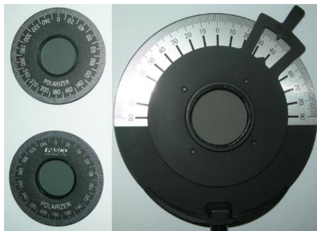
Σχήμα 13.5. Γραμμικοί πολωτές (polaroid). Αριστερά, ο άξονας πόλωσης σημειώνεται με τις ενδείξεις 0-180. Δεξιά, ο άξονας πόλωσης ταυτίζεται με τον (περιστρεφόμενο) βραχίονα. Παρατηρήστε το χρώμα των πλαστικών φύλλων.
