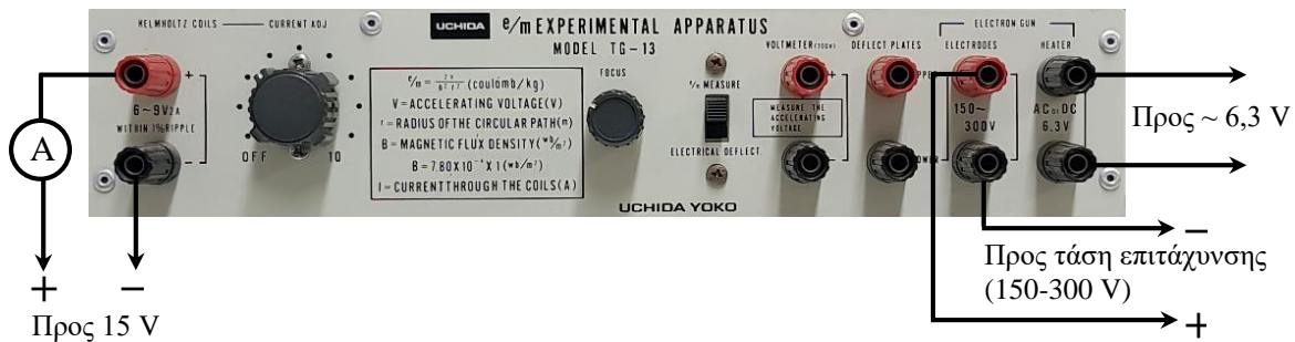
Σχήμα 14.5. Το κιβώτιο συνδεσμολογίας για την τροφοδοσία της λυχνίας και των πηνίων.
