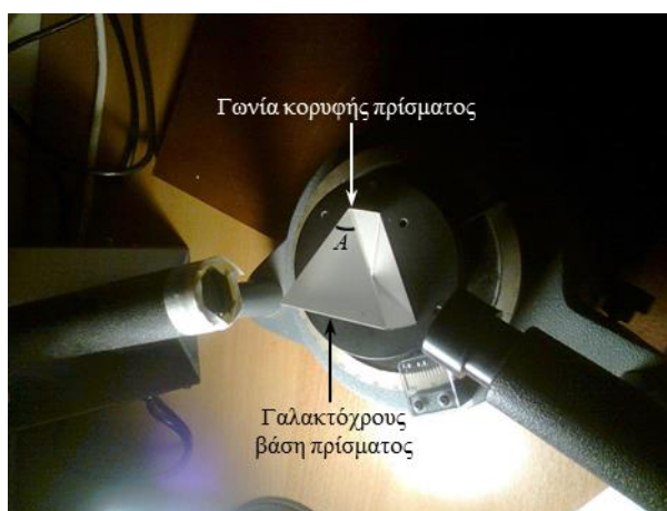
Σχήμα 27.7. Τοποθέτηση πρίσματος πάνω στην οπτική τράπεζα.
