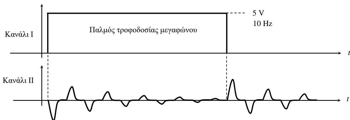
Σχήμα 28.7. Οι παλμοί του μικροφώνου από διαδοχικές ανακλάσεις του ήχου, όταν το ελεύθερο άκρο του σωλήνα είναι ανοικτό, όπως αυτοί φαίνονται στην οθόνη του παλμογράφου (Βλ. Π28.6).
