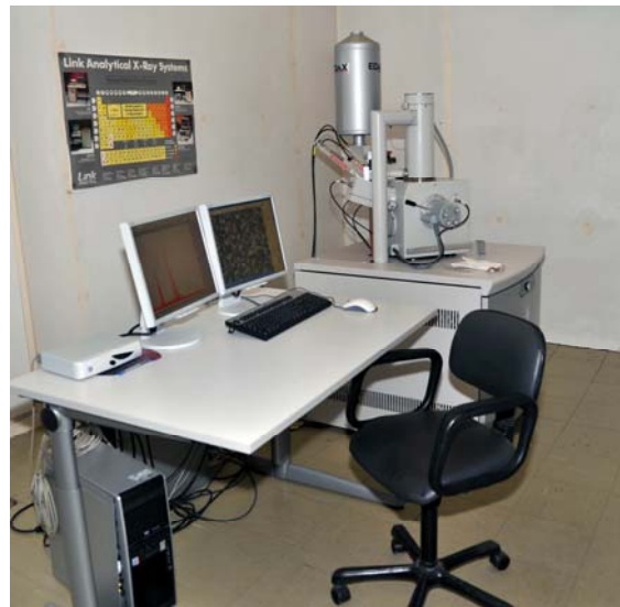
Σχήμα 15. Σχηματικό διάγραμμα SEM και φωτογραφία ενός FEI INSPECT SEM.
