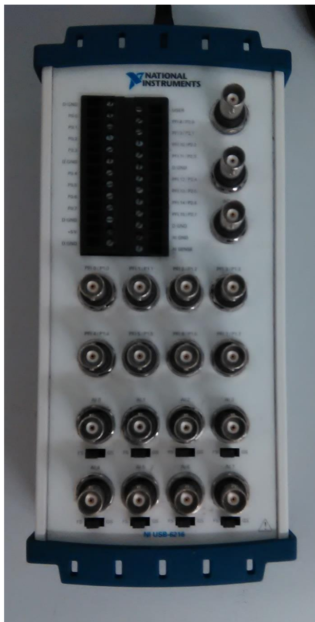
Εικόνα 54: Η κάρτα ψηφιοποίησης σήματος NI USB-6216 της πειραματικής διάταξης.
