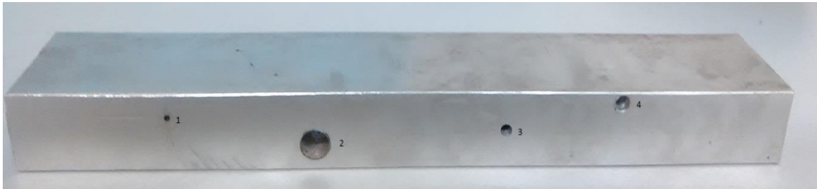
Εικόνα 56: Η διάταξη με τις διαπερατές τρύπες που χρησιμοποιήσαμε στο πείραμα. Μελετήθηκαν οι (2) και η (4).
