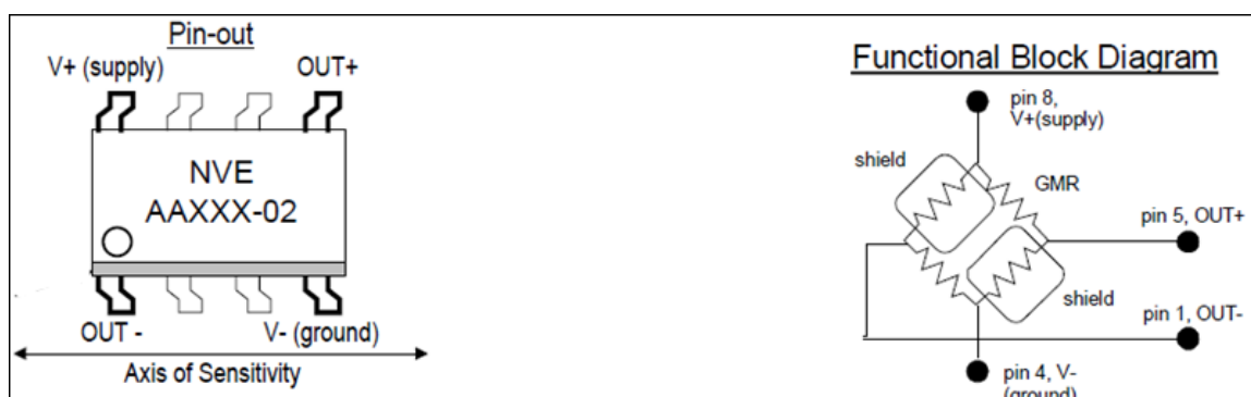
Εικόνα 50: Στην αριστερή εικόνα φαίνεται η κεφαλή του ανιχνευτή στον άξονα ευαισθησίας του, η παροχή τάσης και οι έξοδοι του. Στην αριστερή εικόνα φαίνεται το κύκλωμα μέσα στον ανιχνευτή. Πηγή: GMR sensor catalog, NVE corporation.
