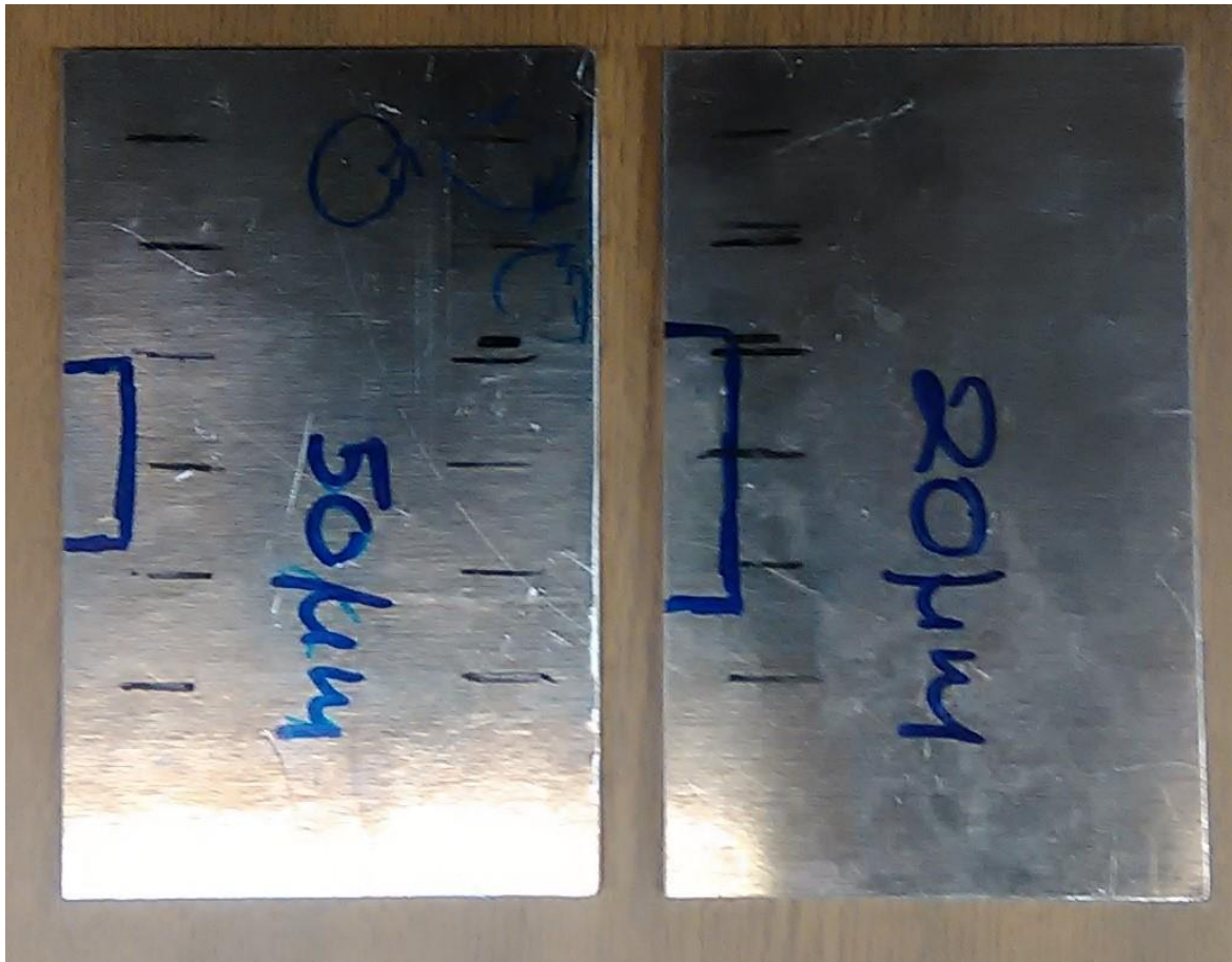
Εικόνα 55: Οι πλάκες αλουμινίου που χρησιμοποιήθηκαν στην ανίχνευση των ρωγμών. Αριστερά η πλάκα με εγκοπή πάχους 50μm στη μία πλευρά της και στα δεξιά η πλάκα με την εγκοπή πάχους 20μm στη μία πλευρά της.
