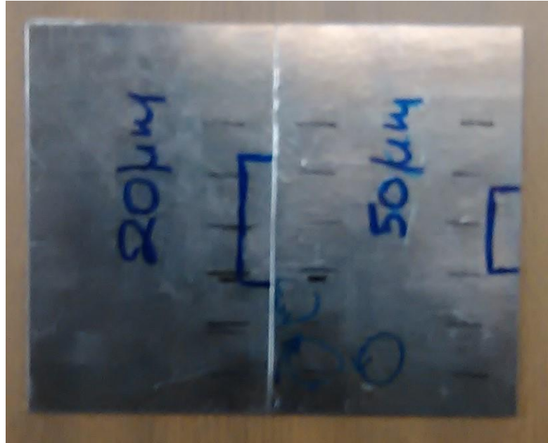
Εικόνα 58: Ρωγμή πάχους 20 \mu\text{m} .
