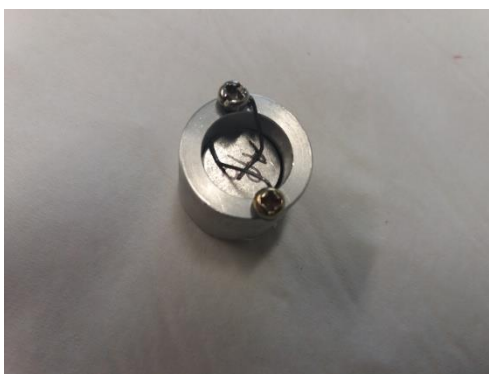
Εικόνα 2.3: Holder με παστίλες τοποθετημένες σε σειρά Al, Hg, Au, Tl, Nb, Ge, Al
