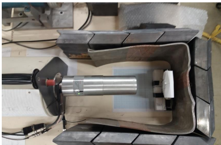
Εικόνα 3.1 : Θωράκιση με τούβλα μολύβδου και φύλλο καδμίου γύρω από τον ανιχνευτή
