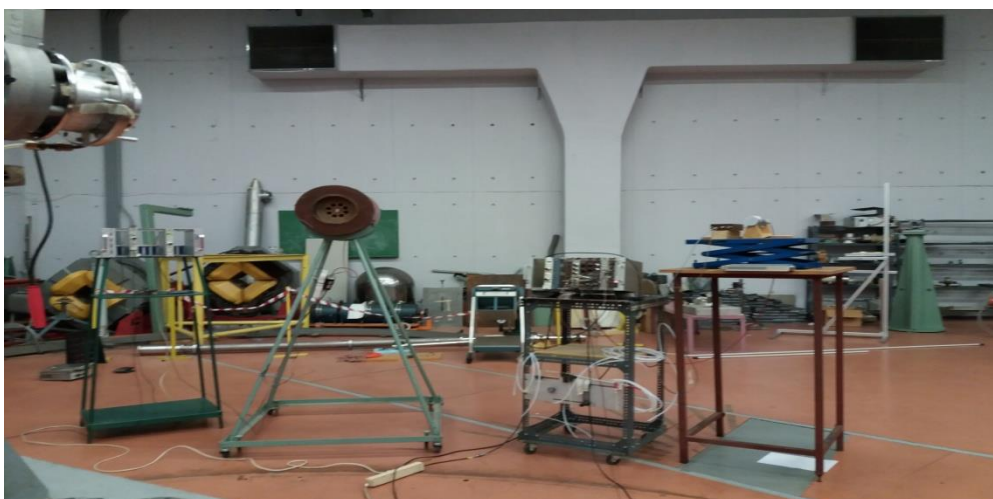
Εικόνα 2.7: Τοποθέτηση των ανιχνευτών σε απόσταση απόσταση 3m από τον στόχο τρίτιου για την καλύτερη καταγραφή της διακύμανσης της έντασης της δέσμης νετρονίων κατά την διάρκεια της μέτρησης
