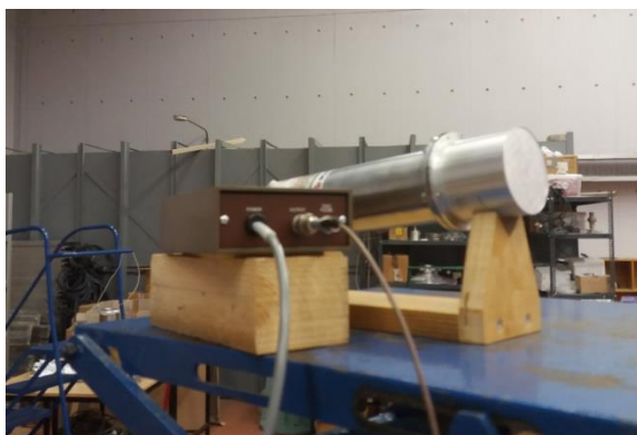
Εικόνα 2.6: Οργανικός Σπινθηριστής (Liquid Scintillator)
