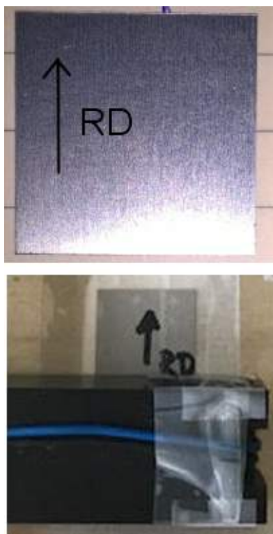
Σχήμα 4.58: Πάνω: Το έλασμα 14 (κράμα Fe-Si), το οποίο έχει διαστάσεις (24.90 \times 24.95) \text{ mm}^2 και πάχος 0.51 \text{ mm} . Κάτω: Το έλασμα 14 (κράμα Fe-Si) κατά τη λήψη μετρήσεων με τον αισθητήρα GMR AA002-02e.
