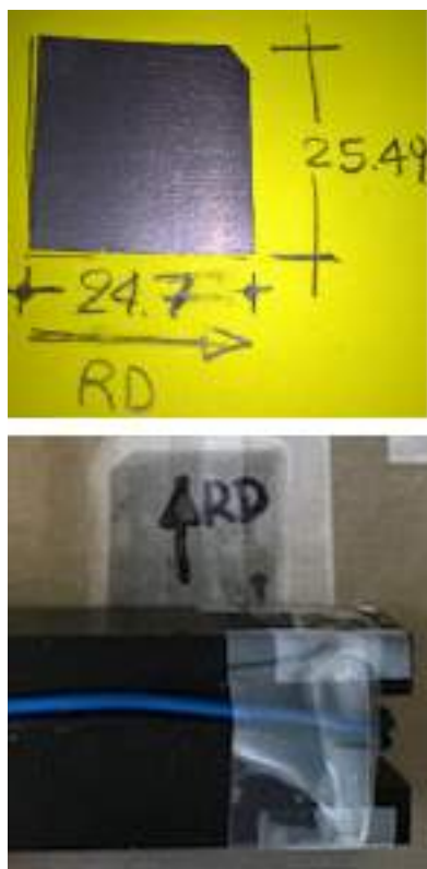
Σχήμα 4.66: Πάνω: Το έλασμα 15 (κράμα Fe-Si), το οποίο έχει διαστάσεις (24.70 \times 25.49) \text{ mm}^2 και πάχος 0.31 mm. Κάτω: Το έλασμα 15, κατά τη διάρκεια των μετρήσεων με χρήση αισθητήρα GMR AA002-02e.
