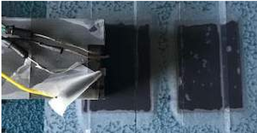
Σχήμα 4.27: Μέτρηση του μαγνητικού πεδίου των δειγμάτων 1 και 2, τα οποία προέκυψαν έπειτα από κοπή του ελάσματος 2.
