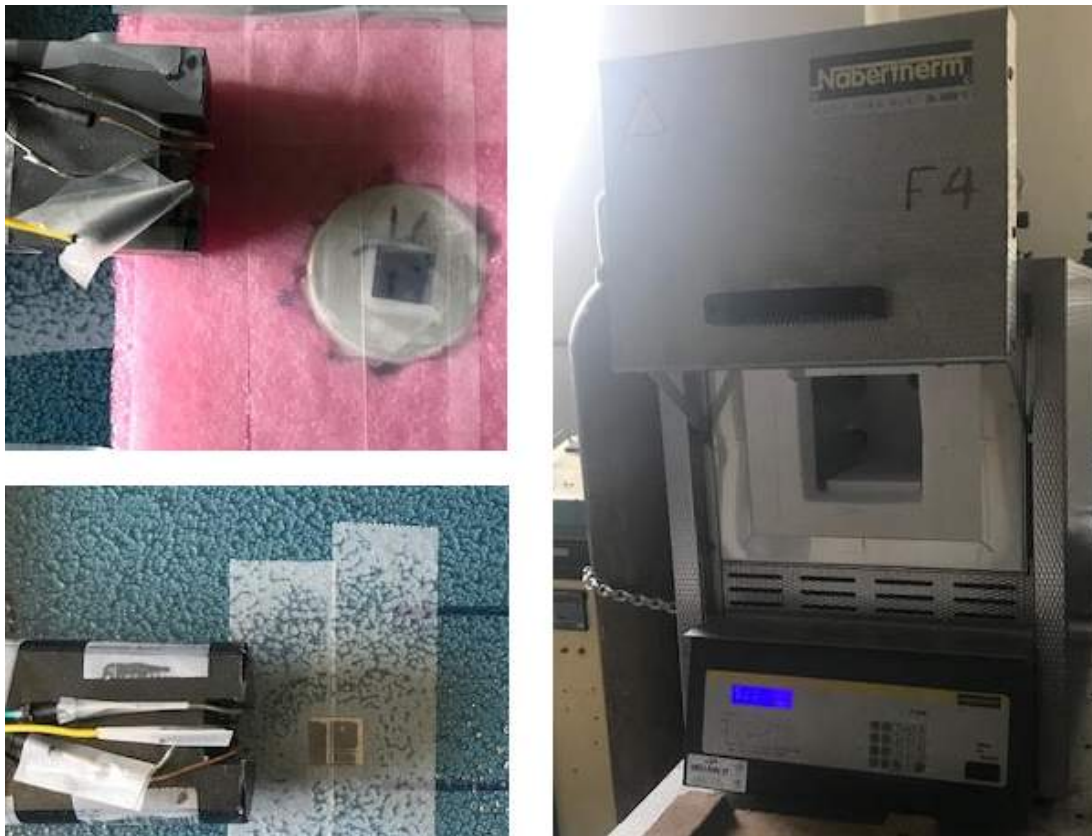
Σχήμα 4.43: Πάνω αριστερά: Το δείγμα 1 (κράμα Fe-C) στην επιφάνεια του μαγνήτη \text{Nd}_2\text{Fe}_{14}\text{B}_2 , κατά τη λήψη των μετρήσεων. Δεξιά: Ο κλίβανος στον οποίο το δείγμα 1 υπέστη ανόπτηση (Ινστιτούτο Νανοτεχνολογίας, ΕΚΕΦΕ Δημόκριτος). Κάτω αριστερά: Το δείγμα 1, έπειτα από θερμική ανόπτηση στους 600\text{ }^\circ\text{C} .
