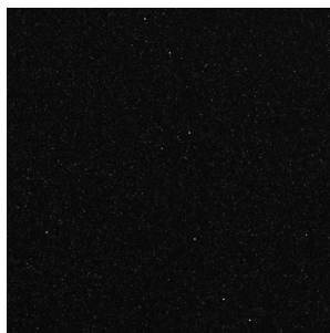
Σχήμα 7: Εικόνα ενός τυπικού dark frame. Τα φωτεινά pixels της εικόνας αντιπροσωπεύουν hot pixels,[20].
