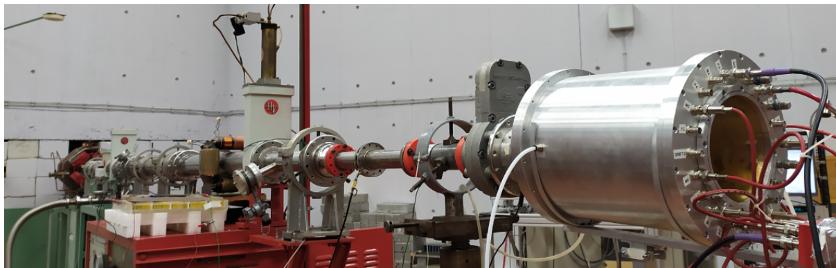
Σχήμα 2.2: Άποψη της γραμμής μεταφοράς της δέσμης, στο τέλος της οποίας βρίσκεται ο πειραματικός θάλαμος.
