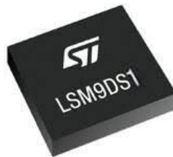
Εικόνα 3-10 Η μονάδα μέτρησης αδράνειας (IMU). Πηγή: STMicroelectronics
