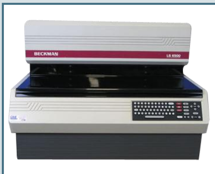
Εικόνα 1.2. (α) Ανιχνευτής υγρού σπινθηρισμού. (β) Ραδιενεργά ισότοπα που συνήθως ανιχνεύονται με ανιχνευτές υγρού σπινθηρισμού.
