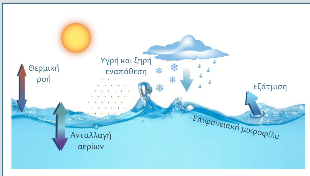
Εικόνα 2.1. Σχηματική αναπαράσταση της διεπιφάνειας αέρα – νερού.
