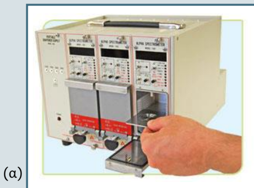
Εικόνα 1.5. (α) Ανιχνευτής α-ακτινοβολίας. (β) Φάσμα α-ακτινοβολίας των θυγατρικών του ραδονίου
