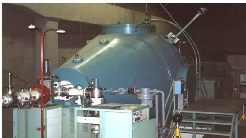
Σχήμα 2.1 Η δεξαμενή εντός της οποίας βρίσκεται η γεννήτρια Van de Graff.
