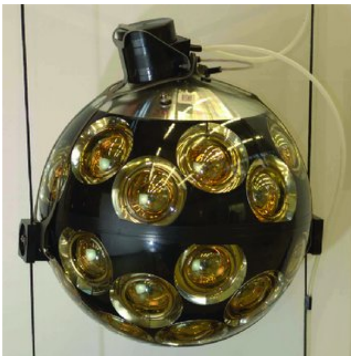
Σχήμα 2.4: Ένα DOM του ανιχνευτή ARCA συνδεδεμένο με τα σχοινιά της ανιχνευτικής μονάδας. Τα PMTs με την ίδια πολική γωνία (ή ισοδύναμα με το ίδιο ύψος από το κατώτερο σημείο του) συνιστούν ένα ring.
