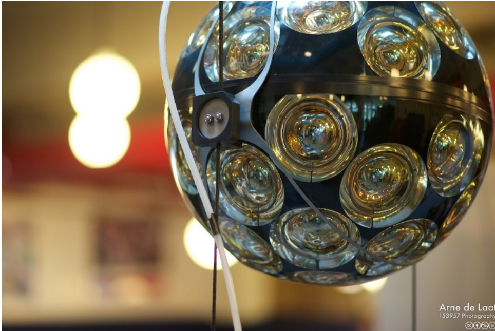
Σχήμα 2.5: Άποψη ενός DOM. Διακρίνονται οι φωτοπολλαπλασιαστές του καθώς και η σύνδεση του στο σχοινί της ανιχνευτικής μονάδας μέσω του κολάρου.
