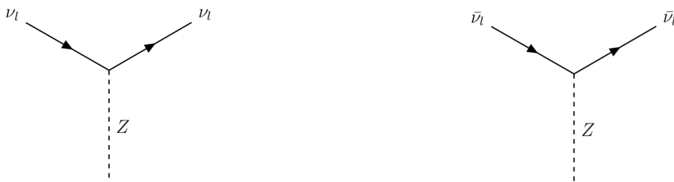
Σχήμα 1.4: Vertices αλληλεπίδρασης \nu_l και \bar{\nu}_l όπου l = e, \mu, \tau μέσω του μποζονίου Z .
