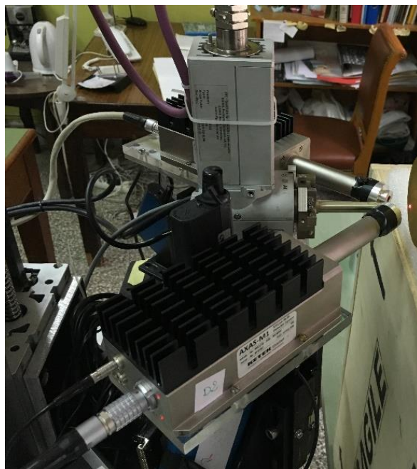
Εικόνα 2.9: Το φασματόμετρο LANDIS-X του εργαστηρίου LANDIS του INFN-LNS (Catania).
