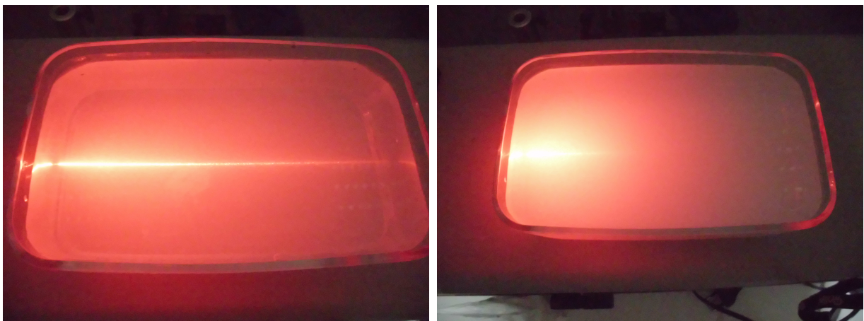
Σχήμα 5.6: Το δοχείο αριστερά περιέχει λιγότερη ποσότητα \text{TiO}_2 από αυτό δεξιά. Το φαινόμενο της σκέδασης και διάχυσης είναι εντονότερο στη δεύτερη περίπτωση .
