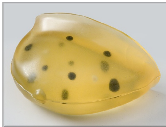
Σχήμα 4.10: Προσομοιωτής γυναικείου μαστού με μικρά ενθέματα που αναπαριστούν όγκους διαφορετικής βιολογικής σύστασης
