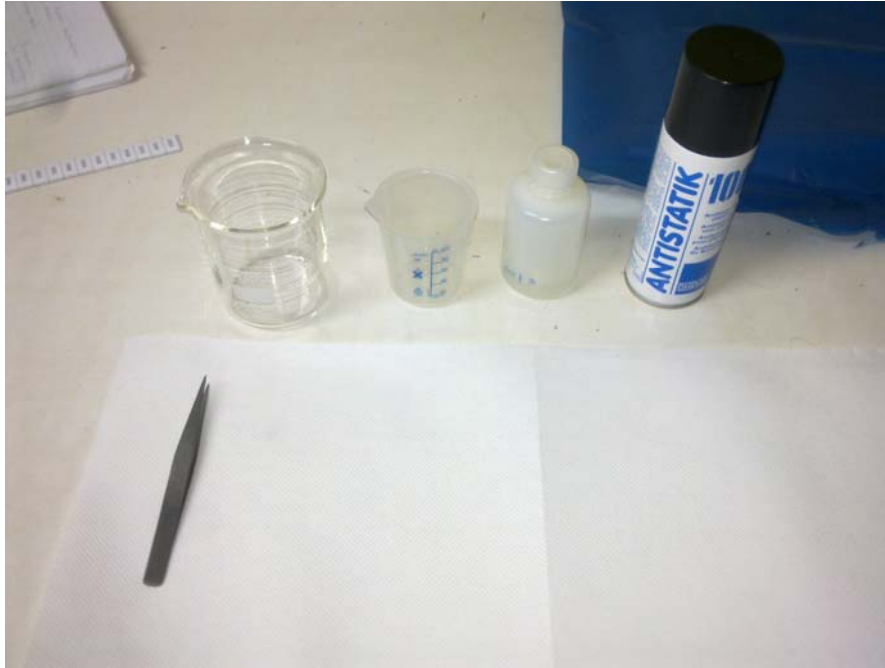
Σχήμα 4.12 Η λαβίδα, το οινόπνευμα, το αποσταγμένο νερό και το αντιστατικό σπρέι για την προετοιμασία των ανιχνευτών
