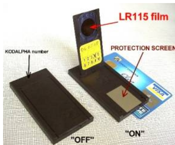
Σχήμα 2.9 Ο ανιχνευτής LR-115 ή αλλιώς Kodalpha και η διάταξη
