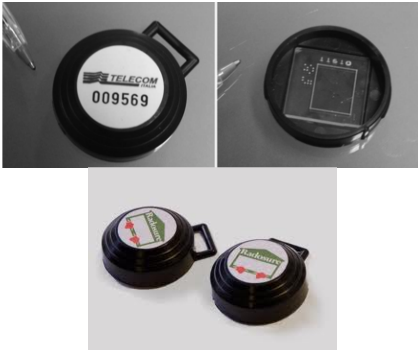
Σχήμα 2.8 Ο ανιχνευτής CR-39 (διάφανο φιλμ) και το δοσίμετρο της διάταξης
