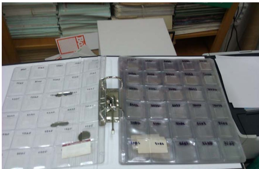
Σχήμα 5.9 Οι εκτεθειμένοι ανιχνευτές αφού καταμετρηθούν, ταξινομούνται και φυλάσσονται με βάση τον αύξοντα αριθμό τους σε ειδικές πλαστικές θήκες.
