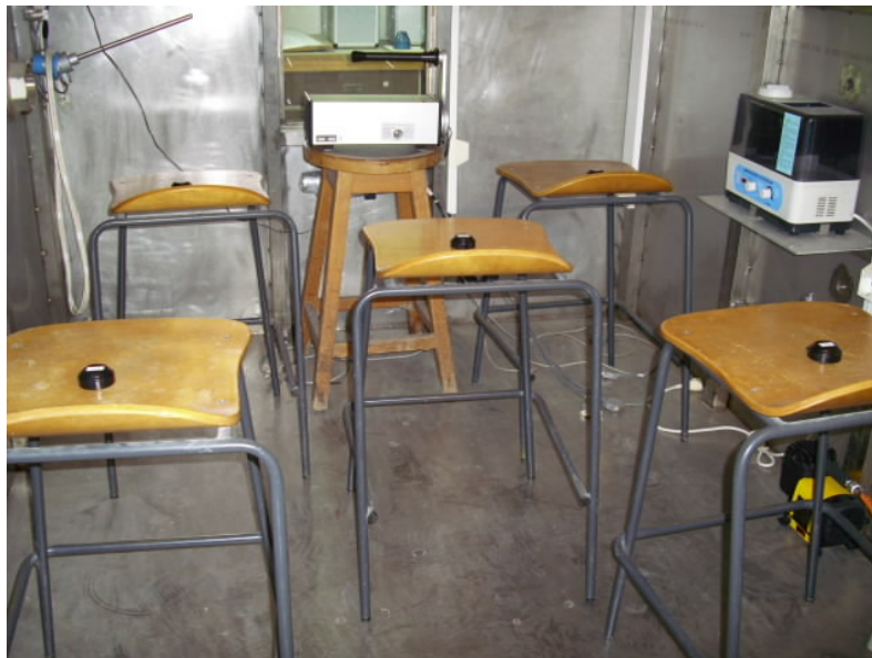
Σχήμα 5.2 Η τοποθέτηση πέντε ανιχνευτών σε διαφορετικά σημεία στο εσωτερικό του θαλάμου ραδονίου
