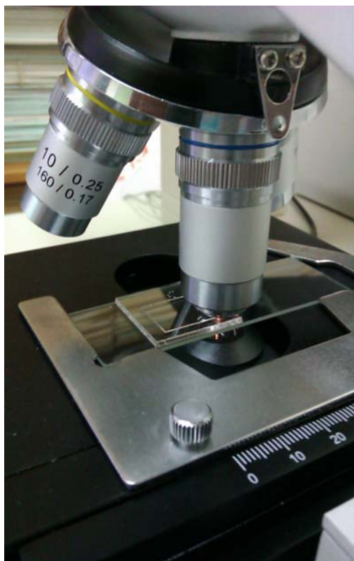
Σχήματα 5.7, 5.8 Το ηλεκτρονικό μικροσκόπιο που χρησιμοποιήθηκε και η τοποθέτηση του ανιχνευτή στην τράπεζα για την ανάγνωση των ιχνών
