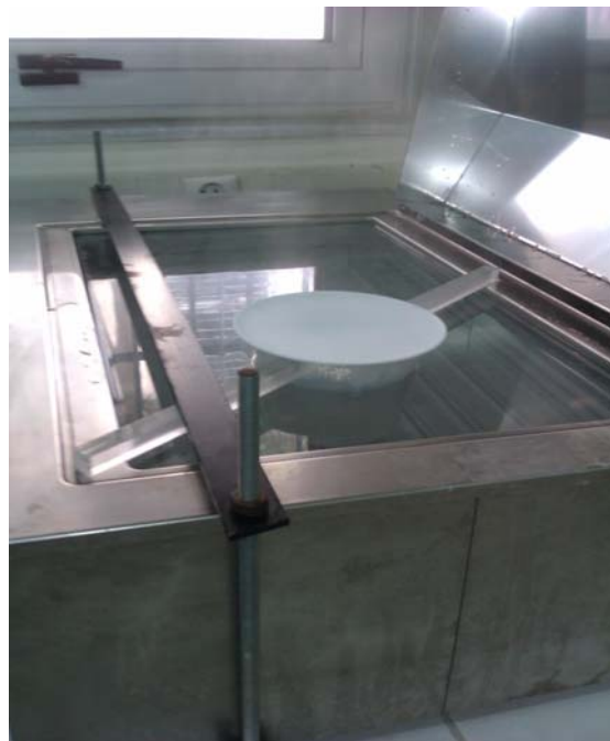
Σχήμα 5.6 Διακρίνονται το λουτρό ζέσεως με το ποτήρι που περιλαμβάνει το διάλυμα με τα holder και τα δοσίμετρα. Επίσης φαίνονται η ράβδος που συγκρατεί το ποτήρι και το προστατευτικό καπάκι.
