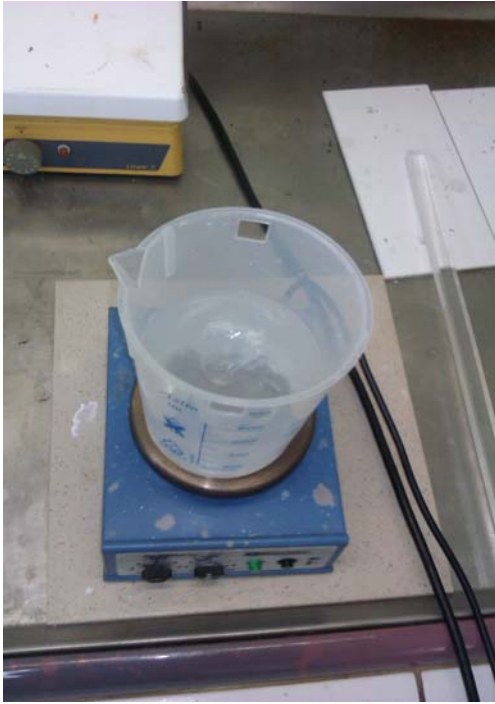
Σχήματα 5.4, 5.5 Ο μαγνητικός αναδευτήρας στον οποίο τοποθετείται το ποτήρι όπου περιέχει το διάλυμα για την χημική διάβρωση των ανιχνευτών
