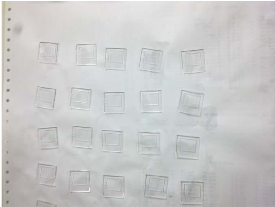
Σχήμα 4.9 Τα φιλμ κατά την προετοιμασία πριν κλειστούν στα cups και πριν εκτεθούν
