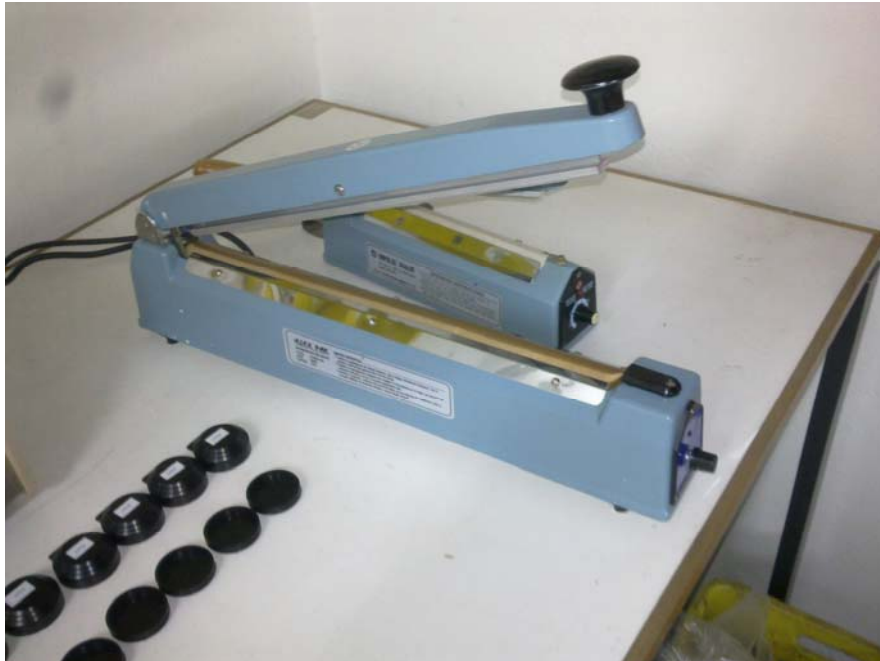
Σχήμα 4.10 Η συσκευή θερμοκόλλησης που χρησιμοποιήθηκε για την σκεύαση των προστατευτικών σακκούλων που περιείχαν τα δοσίμετρα
