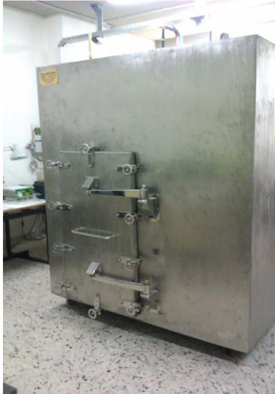
Σχήμα 5.1 Ο θάλαμος ραδονίου των 8.5 m 3 του Τ.Π.Τ. του Ε.Μ.Π. που χρησιμοποιήθηκε για την έκθεση των ανιχνευτών κατά την διαδικασία της βαθμονόμησης
