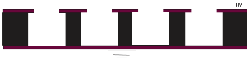
Σχήμα 6.2.: Τα kapton pillars, που υποβαστάζουν το micromesh και διασφαλίζουν την ομοιογένεια του amplification gap [5].
