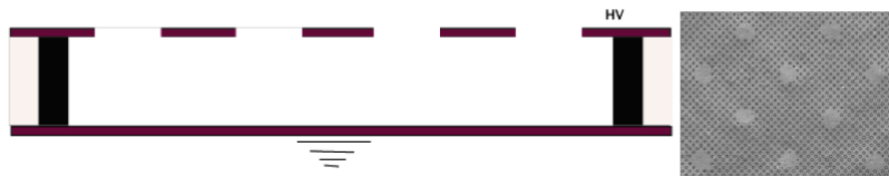
Σχήμα 6.7.: Τα kapton pillars της τεχνικής floating mesh [5] .
