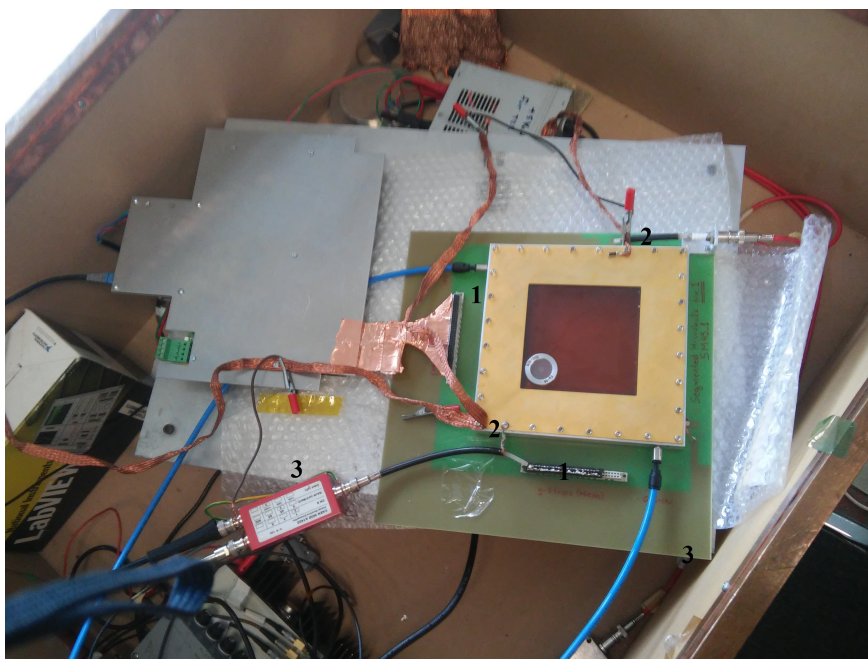
Σχήμα 7.1.: Ο ανιχνευτής segmented mesh microbulk του εργαστηρίου με πηγή Fe^{55} στο παράθυρο ανίχνευσης.
