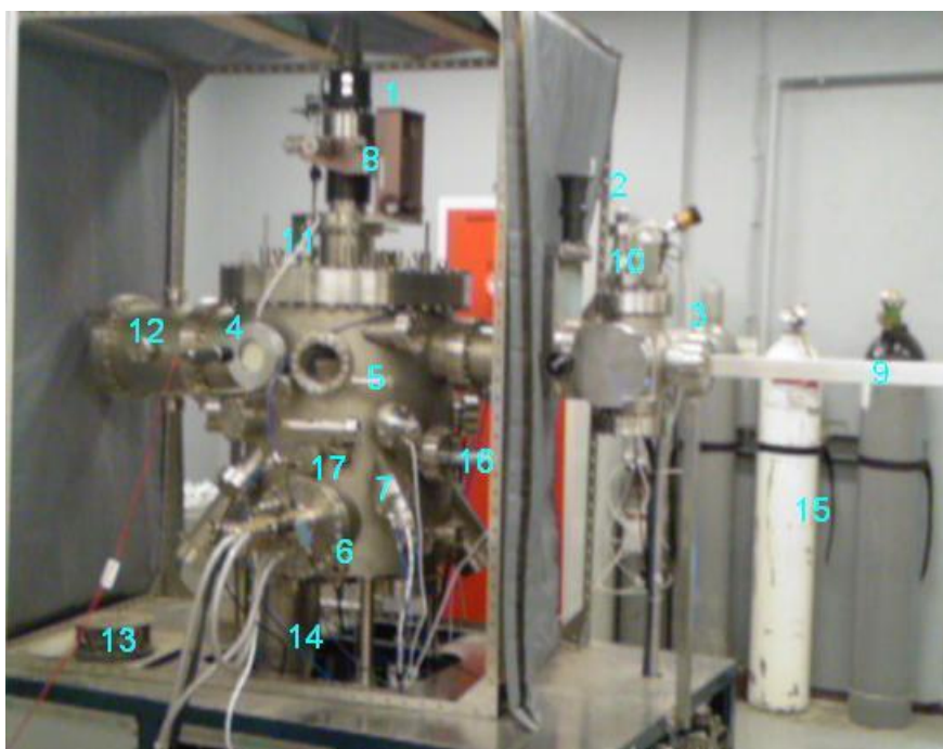
Σχήμα 4.1: Διάταξη MBE DCA 600, πρόσθια όψη
