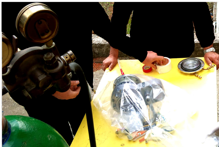
Εικόνα 2.4: Η τοποθέτηση του στόχου του τριτίου στη φλάντζα, η οποία πραγματοποιείται μέσα σε αεροστεγή σάκο απομόνωσης, σε εξωτερικό χώρο.
