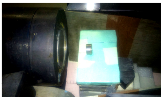
Εικόνα 3.2: Μέτρηση του δείγματος Am μετά την ακτινοβολήση, στα 7 cm, από τον ανιχνευτή γερμανίου (απόδοσης 100%), για 85353 s.
