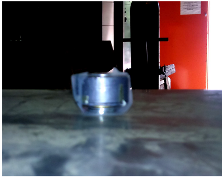
Εικόνα 2.10: Το κέλυφος μολύβδου, μέσα στο οποίο βρίσκεται η πηγή του Am, κολλημένο μαζί με τους στόχους αναφοράς (στο εμπρός και στο πίσω μέρος του), λίγο πριν την έναρξη της ακτινοβόλησης.
