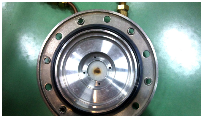
Εικόνα 2.7: Στη δοκιμή τοποθετήθηκε ένα κομμάτι χαρτιού, στη θέση του στόχου του τριτίου, προκειμένου να γίνει ορατή η διατομή της δέσμης των δευτερίων (beam spot).
