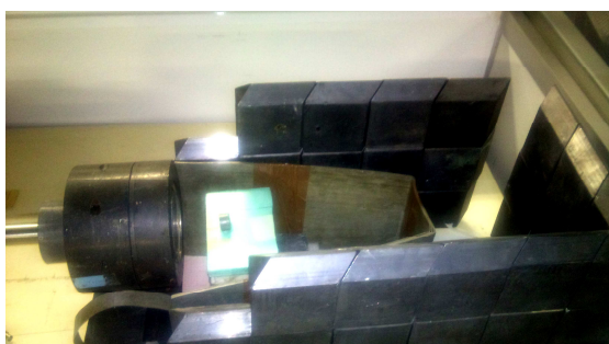
Εικόνα 3.1: Μέτρηση του δείγματος Am πριν την ακτινοβολήση, στα 7 cm, από τον ανιχνευτή γερμανίου (απόδοσης 100%), για 31850 s.
