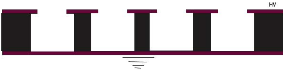
Σχήμα 2.3: Σχηματική αναπαράσταση της κάθετης τομής του amplification gap ενός microbulk MicroMegas
