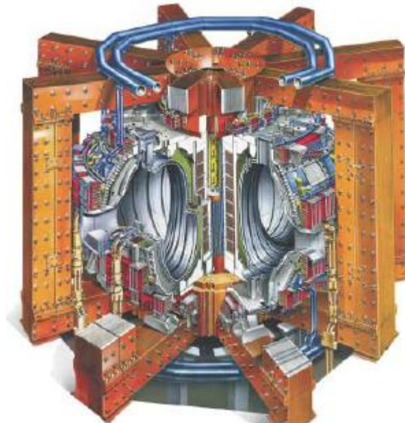
Σχήμα 3.7 Σχηματική αναπαράσταση ενός JET ο οποίος είναι ένας tokamak. [ B.1.13. ]
