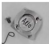
Σχ.2.3: Φωτογραφία του μεταλλικού στηρίγματος στο οποίο τοποθετήθηκαν όλοι οι στόχοι.
