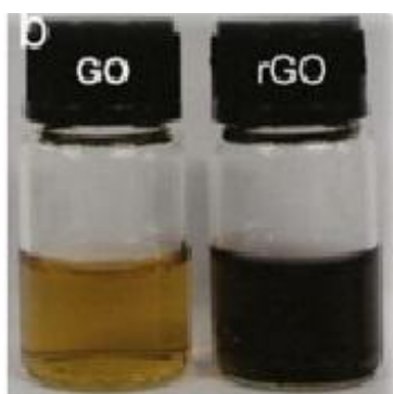
Σχήμα 1.31: Αναγωγή του GO μέσω υδραζίνης και παραγωγή RGO. Είναι φανερή η αλλαγή χρώματος του διαλύματος μετά την αναγωγή.
