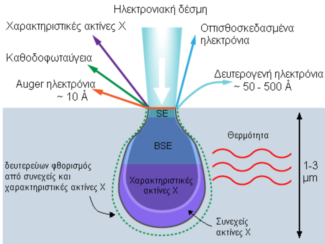
Σχήμα 3.5 Σχηματικό διάγραμμα γεωμετρίας της περιοχής που αλληλεπιδρά με την ηλεκτρονική δέσμη.
