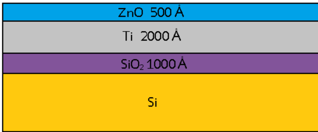
Σχήμα 3.2 Σχηματικό διάγραμμα στρωμάτων (υμενίων) εξαχνωμένων υλικών σε υπόστρωμα Si - \text{SiO}_2 .
