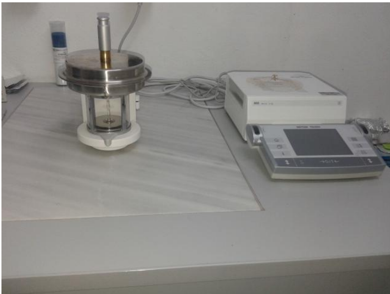
Εικόνα 3.4 Φωτογραφία από το δωμάτιο ζύγισης, όπου παρουσιάζεται ο ζυγός ακριβείας Mettler Toledo MX-5 του εργαστηρίου.
