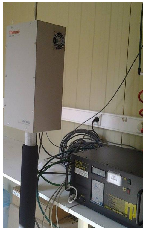
Εικόνα 3.1 Άποψη TEOM και FDMS εντός του container.
