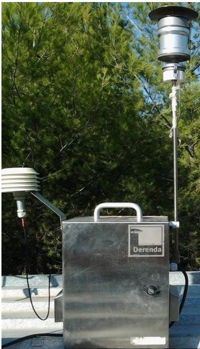
Εικόνα 2.2 Άποψη σταθμικού δειγματολήπτη τύπου Derenda.
