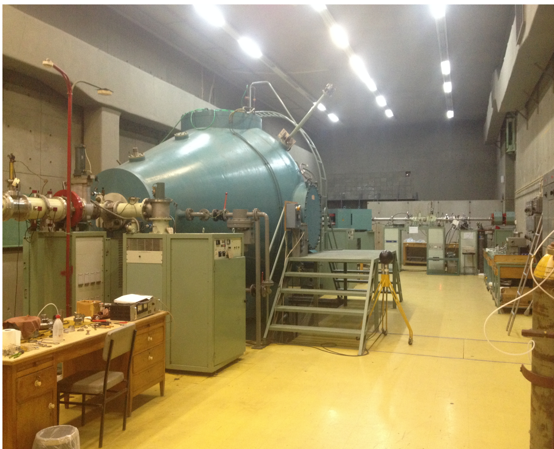
Σχήμα 1 Επιταχυντής Tandem του Ινστιτούτου Πυρηνικής και Σωματιδιακής Φυσικής του Ε.Κ.Ε.Φ.Ε. "Δημόκριτος".
