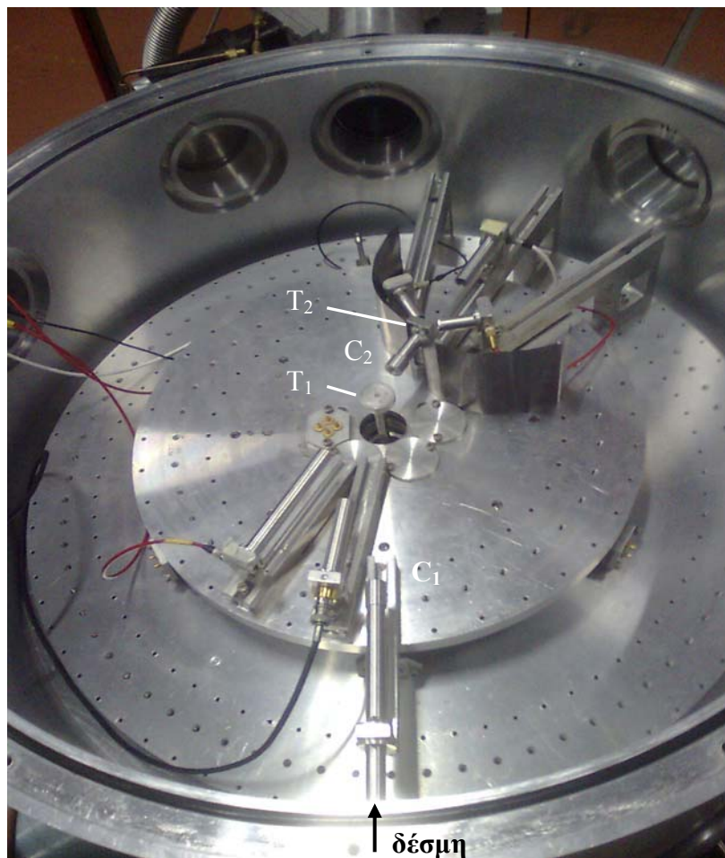
Σχήμα 3: Ο θάλαμος σκέδασης με την απαραίτητη διάταξη ανιχνευτών και στόχων.
