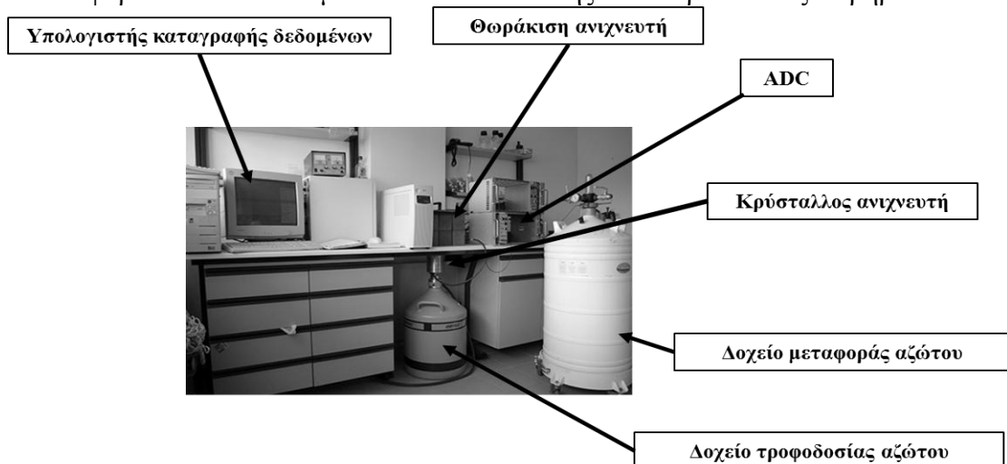
Σχήμα 3.3.1.2.ii: Η πειραματική ανιχνευτική διάταξη φασματοσκοπίας \gamma του ΕΛ.ΚΕ.Θ.Ε., στην οποία μετρήθηκαν τα δείγματα του Στρατωνίου.
