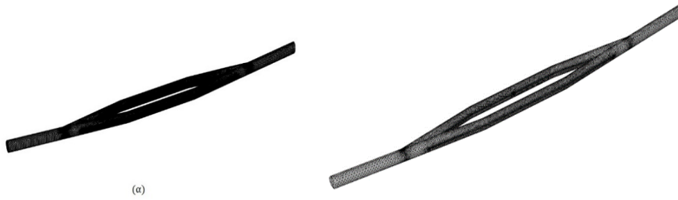
Σχήμα 3.14: (α): Κανονικό πλέγμα και (β): αραιό πλέγμα
