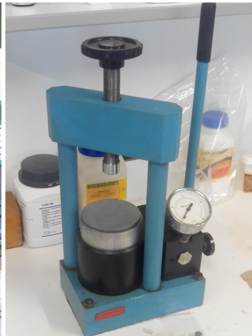
Σχήμα 2.8: Πρέσα εργαστηρίου για την παρασκευή στόχων.
