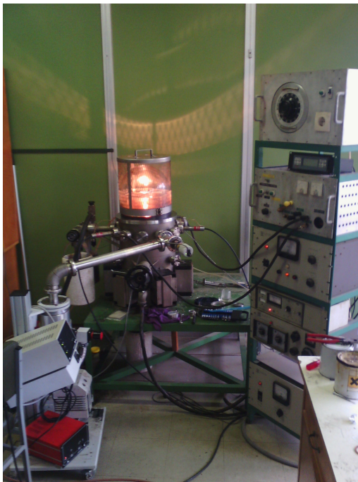
Σχήμα 2.7: Εξαχνωτήρας εργαστηρίου για την παρασκευή στόχων.
