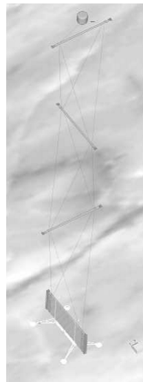
Σχήμα 2.6: Σχηματική αναπαράσταση του ανιχνευτή NESTOR (αριστερά) και του ανιχνευτή NEMO (δεξιά)
