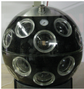
Σχήμα 3.3: Αριστερά : Το ψηφιακό οπτικό στοιχείο (DOM) του KM3NeT. Δεξιά : Σχηματική αναπαράσταση του εσωτερικού του ψηφιακού οπτικού στοιχείου.
