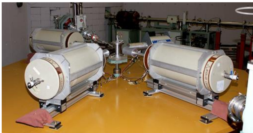
Εικόνα 3.3 Ανιχνευτές τύπου HPGe που χρησιμοποιήθηκαν
