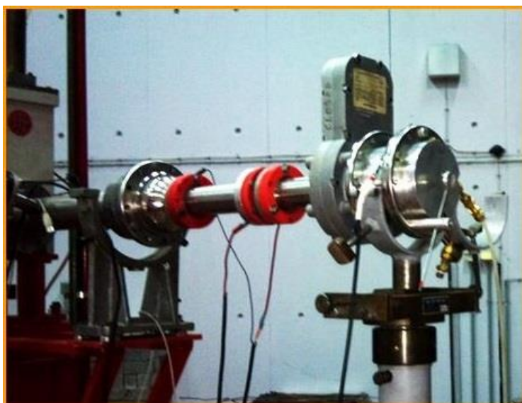
Εικόνα 3.2 Πειραματική διάταξη ακτινοβόλησης δείγματος φυσικού Hf
