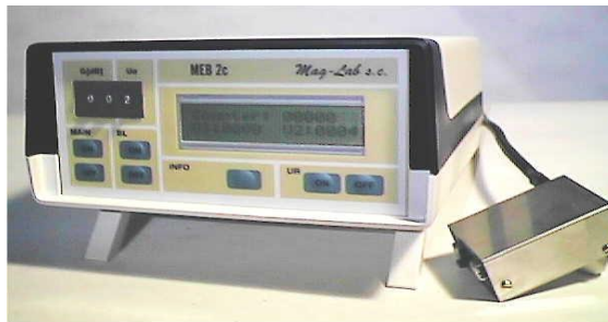
Εικόνα 3-4: Πειραματική διάταξη για τη μέτρηση του μαγνητικού θορύβου Barkhausen.
