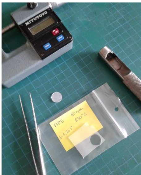
Σχήμα 3.7 Μέτρηση του πάχους της μήτρας (αριστερά), το δοκίμιο με έγκλεισμα 4 wt% σε νανοσωλήνες (δεξιά)
