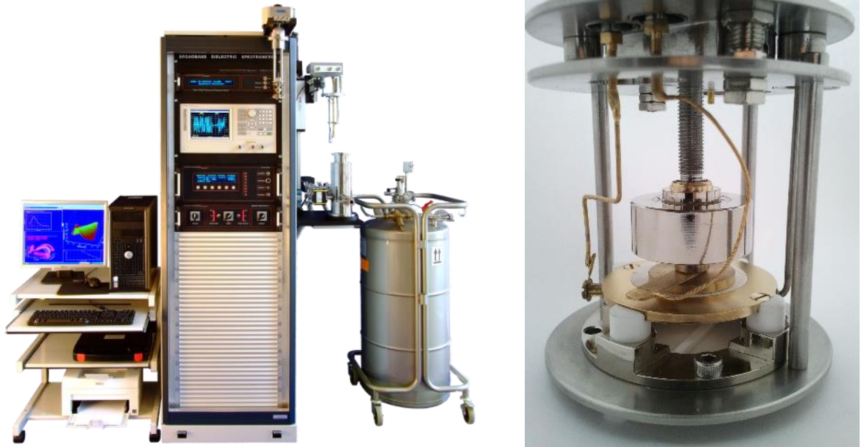
Σχήμα 3.9 Πειραματική Διάταξη DRS, αντίστοιχη με αυτήν του εργαστηρίου Διηλεκτρικής Φασματοσκοπίας (αριστερά). Κυψελίδα μέτρησης (δεξιά).
