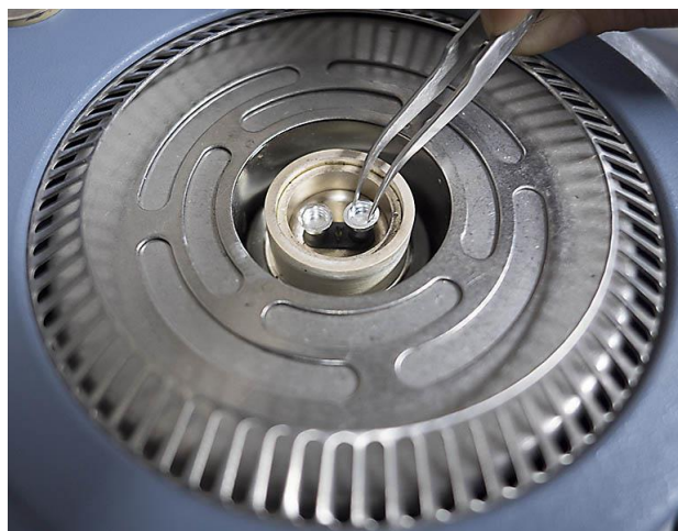
Σχήμα 3.3 Συσκευή DSC Q20 της εταιρίας TA Instruments (Αριστερά). Καψίδια από αλουμίνιο τοποθετημένα εντός του φούρνου (Δεξιά).
