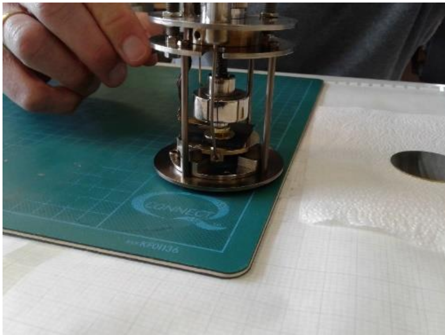
Σχήμα 3.10 Τοποθέτηση δοκιμίου στην κυψελίδα μέτρησης της πειραματικής διάταξης DRS με την οποία πραγματοποιήθηκαν οι μετρήσεις ηλεκτρικής αγωγιμότητας.
