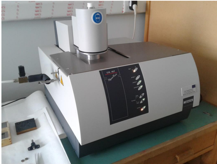
Σχήμα 3.4 Η συσκευή LFA 467 Hyperflash της εταιρίας Netzsch που βρίσκεται στο Εργαστήριο Διηλεκτρικής Φασματοσκοπίας.
