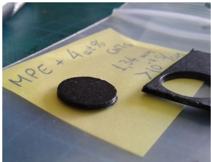
Σχήμα 3.7 Μέτρηση του πάχους της μήτρας (αριστερά), το δοκίμιο με έγκλεισμα 4 wt% σε νανοσωλήνες (δεξιά)
