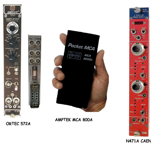
Σχήμα 3.5: Ο ενισχυτής, η μονάδα παροχής τάσης και ο πολυκαναλικός αναλυτής που χρησιμοποιήθηκαν.
