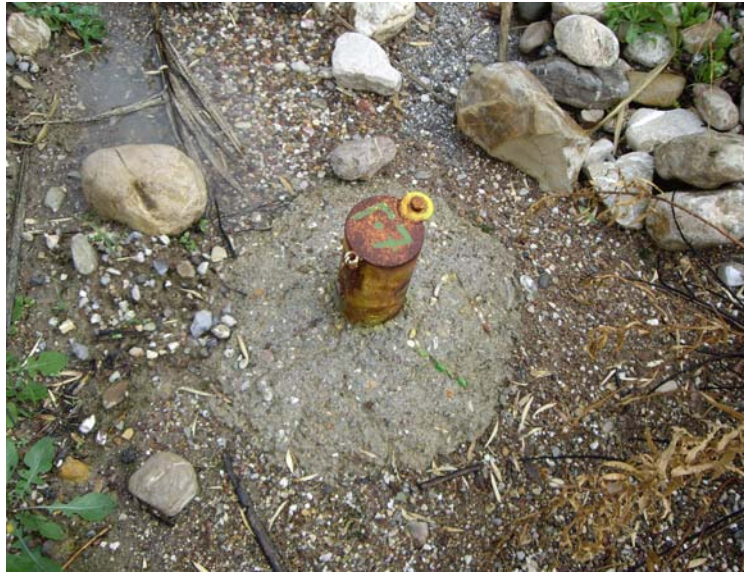
Εικόνα 3-24. Γεωτεχνική γεώτρηση που εντοπίσθηκε εντός της ζώνης αστοχιών στη θέση Ασίκελος.
