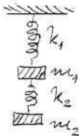
**Θέμα 1°** Το σύστημα του σχήματος αποτελείται από δύο σώματα με ίσες μάζες,  $m_1 = m_2 = m$ , συζευγμένες με ελατήρια σταθεράς  $k_1 = k$  και  $k_2 = 2k$ . Θεωρούμε ότι τα σώματα κινούνται μόνο κατά τη διεύθυνση του πεδίου βαρύτητας.
