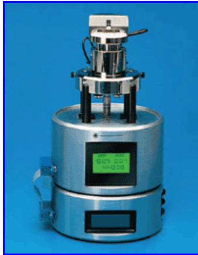
Σχήμα 2.21: Σχήμα Μικροσκόπιο ανίχνευσης ηλεκτροχημικού δυναμικού (SECPM).
