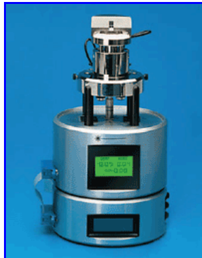
Σχήμα 2.22: Η TRmode τεχνική χρησιμοποιεί τις στρεπτικές ταλαντώσεις της ακίδας του συστήματος AFM για τη σάρωση του δείγματος.
