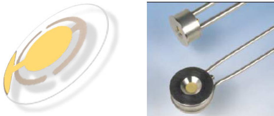
Σχήμα 3.13: Κρύσταλλος χαλαζία και διατάξεις μέτρησης πάχους υμενίων.
