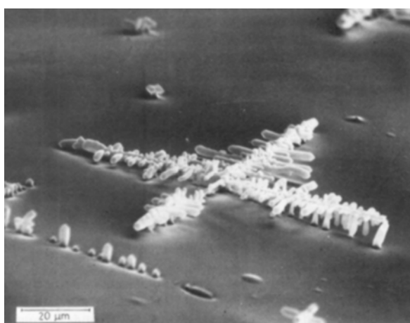
Σχήμα 16. Εικόνα δευτερογενών ηλεκτρονίων ενός πυριτιούχου δενδρίτη σε κράμα νικελίου
